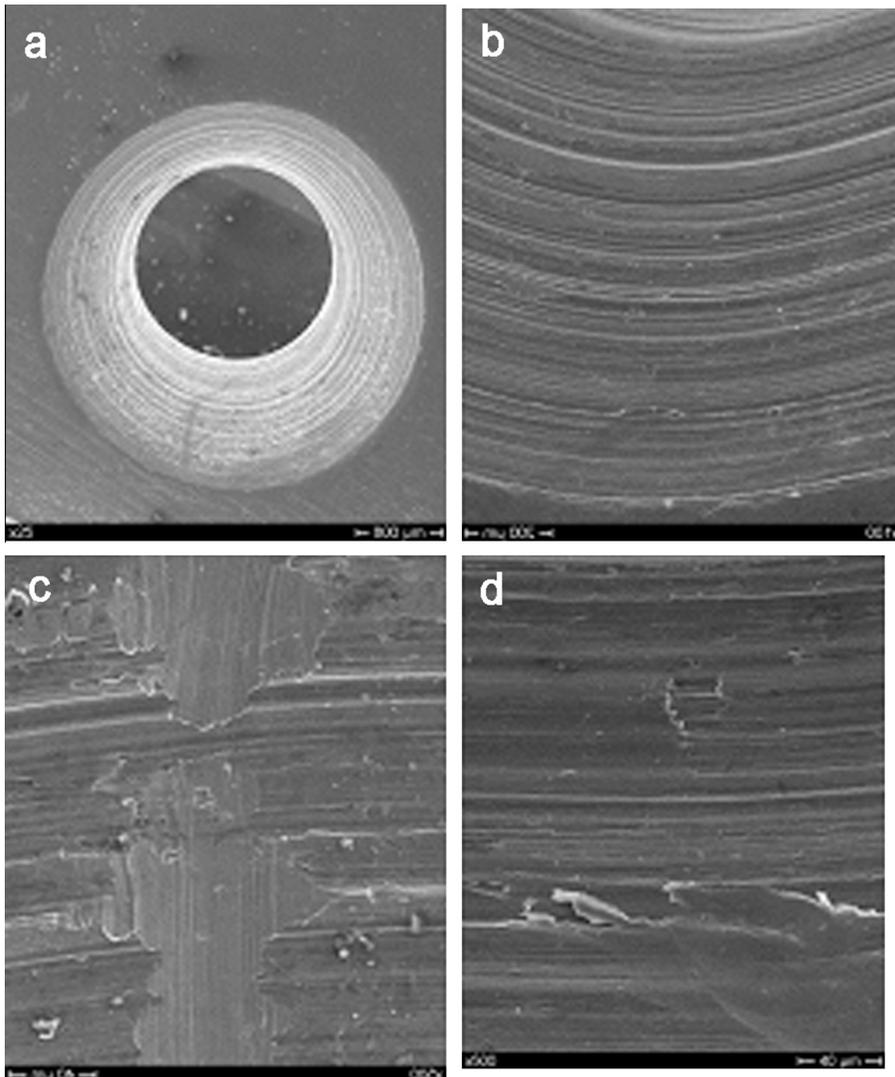
**Fig. 11.** Hole surface finishing – SEM: (a) 25×, (b) 100×, (c) 500×, (d) 500×.
